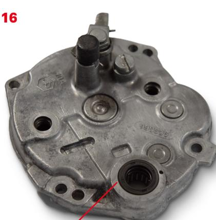
Sostituire paraolio e gabbia a rulli con quelli inseriti nel kit.
