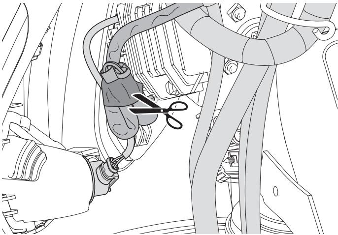
Das Band zur Befestigung des Kabelsteckers **AD** an die Verkabelung des linken Blinkers schneiden.
