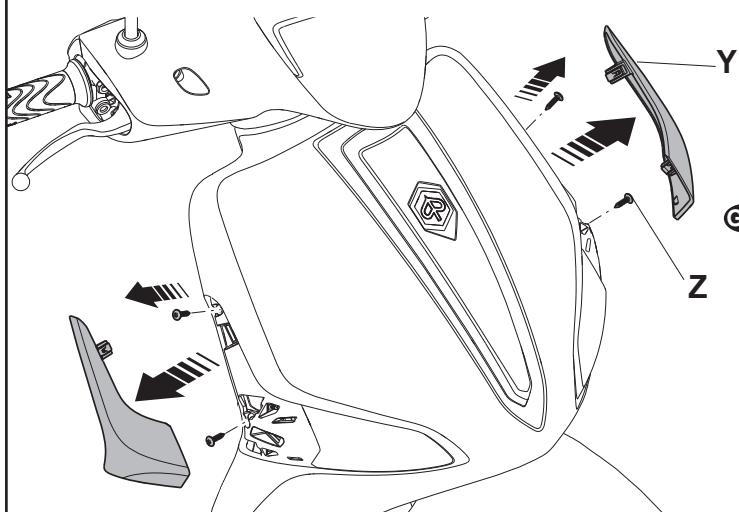
**D** Um die Schild-Rückseite zu entfernen, den vorderen Koffer öffnen und die Befestigungsschraube **T** abschrauben, dann die zwei oberen Schrauben **U**, die zwei unteren Seitenschrauben **V** und die W-Schraube entfernen. Die verchromten Abdeckungen **Y** der vorderen Blinker durch leichtes Ansetzen mit einem Schraubenzieher entfernen. Die vier Schrauben **Z** abschrauben und entfernen.
