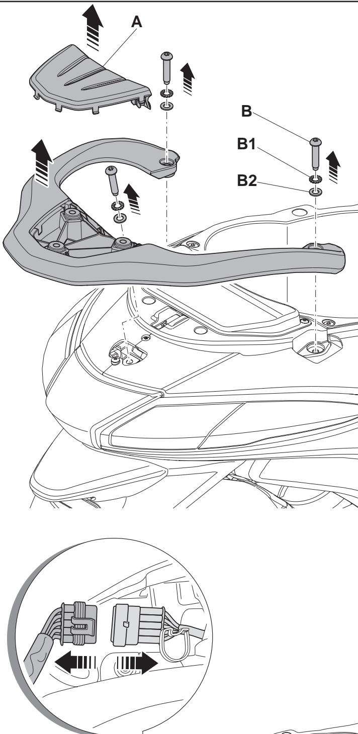
Die Plastikabdeckung des Gepäckträgers **A** entfernen, dabei leicht mit einem Schraubenzieher von unten nach oben ansetzen.
