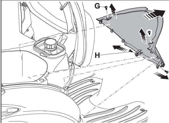
**D** Die zwei oberen **G** und die zwei unteren **H** Befestigungsschrauben der Zündkerzen-Kontrollklappe lösen. Den Sitz schließen und die Klappe vom Scooter entfernen.
