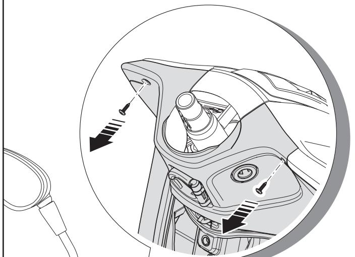
**I** Per rimuovere il controscudo aprire il bauletto anteriore e svitare la vite di fissaggio **T** quindi svitare e togliere le due viti superiori **U** le due viti laterali inferiori **V** e la vite **W**. Rimuovere le cover cromate **Y** degli indicatori di direzione anteriori facendo leva, delicatamente, con un cacciavite. Svitare e togliere le quattro viti **Z**.
