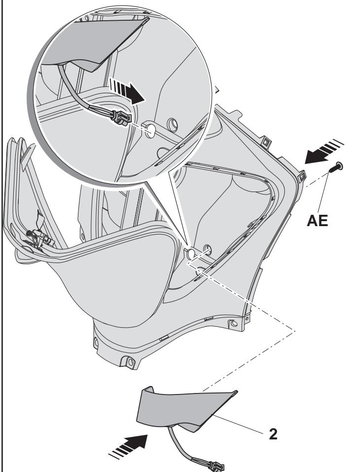
**I** Inserire nella tasca destra **2**, fornita nel kit, dalla parte esterna verso quella interna, la guarnizione in gomma **3** di alloggiamento della presa USB **4**.
