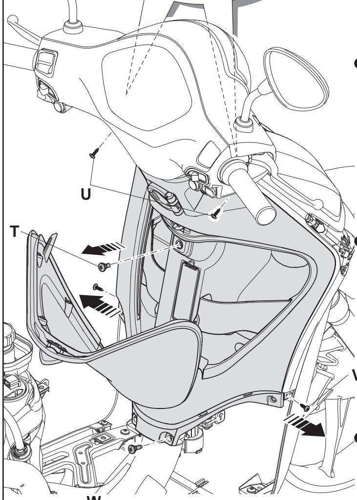
**F** Pour déposer le contre-tablier, ouvrir le coffre avant et dévisser la vis de fixation **T**, puis dévisser et enlever les deux vis supérieures **U**, les deux vis latérales inférieures **V** et la vis **W**. Déposer les caches chromés **Y** des clignotants avant en faisant levier, doucement, avec un tournevis. Dévisser et enlever les quatre vis **Z**.
