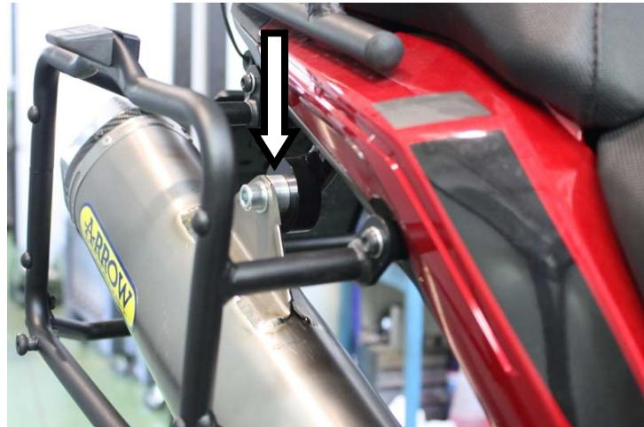
**IT** · Innestare il terminale e serrare l'attacco interponendo col telaio lo spessore fornito
