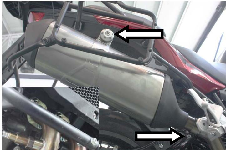
**IT** · Innestare il terminale originale, serrare l'attacco, i collettori ai cilindri e la fascetta
