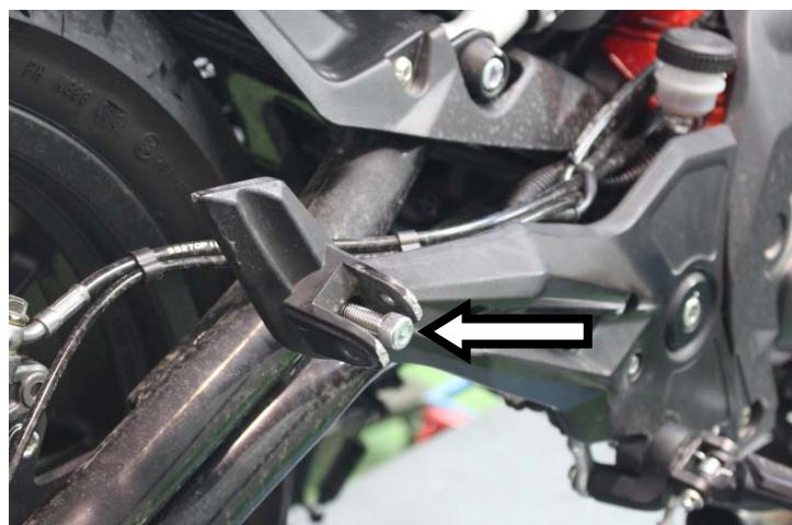
**IT** · Inserire nel foro della pedana una delle viti fornite
