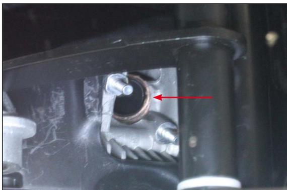
Verificare che la guarnizione al cilindro sia correttamente
