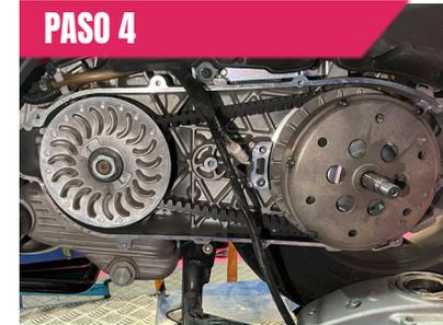
Retira la tuerca del embrague, sus arandelas y la tapa de transmisión
