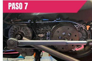
Instala la semi-polea, bloquea el variador y aprieta el variador con dinamométrica
