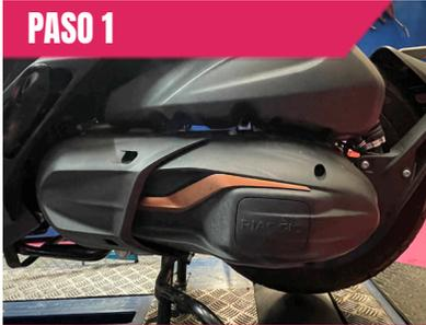
Localiza la tapa del sistema de transmisión automático
