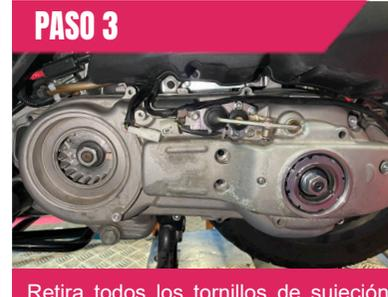
Retira todos los tornillos de sujeción de la tapa, la tapa de plástico y desconecta la clema
