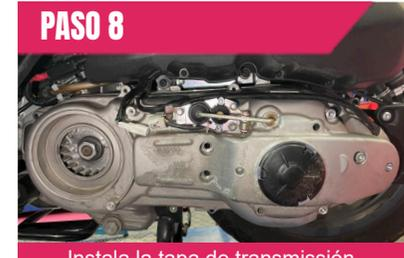
Instala la tapa de transmisión, aprieta la tuerca del embrague al par original (7,5KG/75NM) y coloca todos los tornillos.
