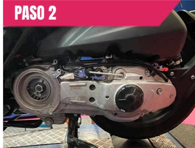
Retira la tapa del sistema de transmisión automático
