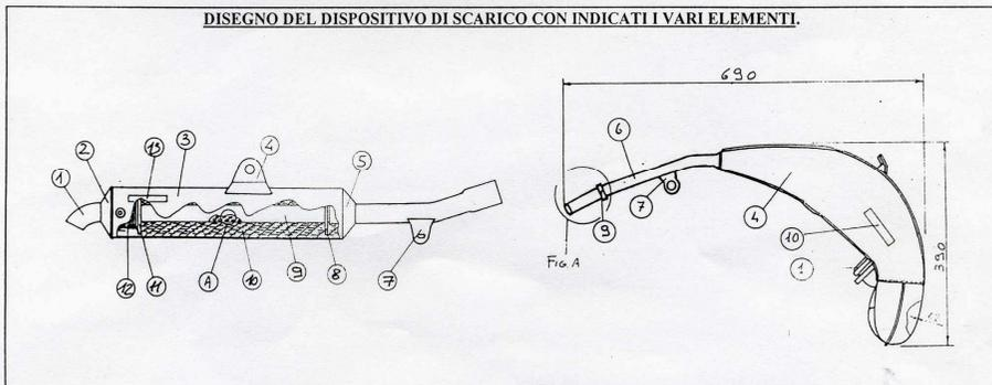
Lo scarico di sostituzione GIANNELLI per il montaggio utilizza gli attacchi al motore e al telaio già utilizzati dal dispositivo di scarico originale.
