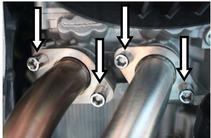
**IT** · Innestare i collettori ai cilindri e serrare senza stringere completamente le flange ai prigionieri mediante dadi originali
