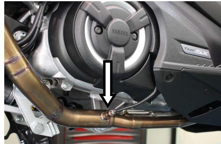
**IT** · Serrare i collettori ai cilindri ed avvitare la sonda lambda
