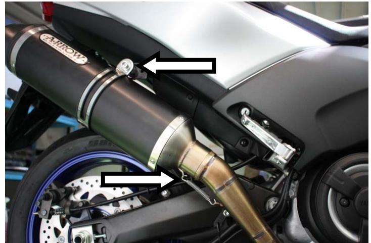
**IT** · Innestare il terminale, serrare l'attacco al telaio mediante fascetta interponendo lo spessore fornito ed ancorare la molla
